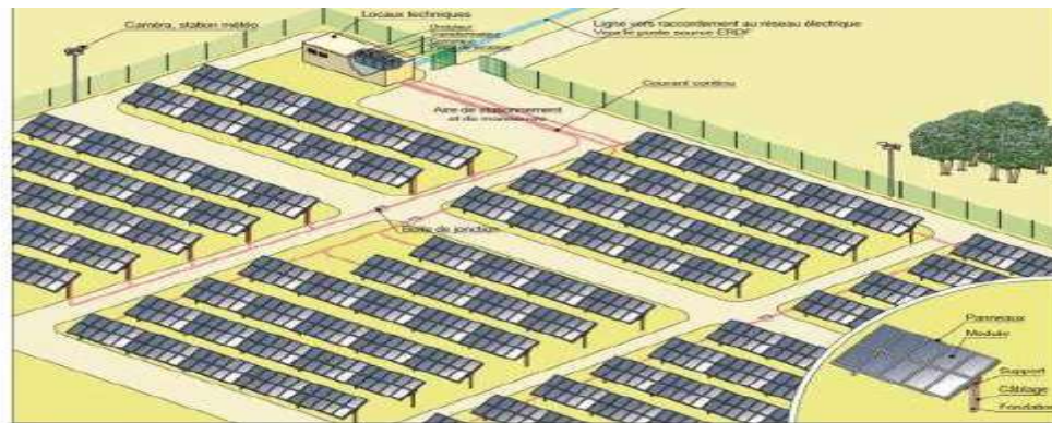
Figure 4 : Schéma de principe d'une installation photovoltaïque (source : Guide de l'étude d'impact – Installations photovoltaïques au sol – MEDDTL, avril 2011)
