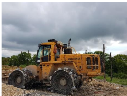
Un compacteur à déchets VANDEL QS 330HD de 33T
