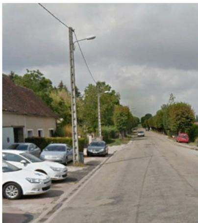
Rue Michel de Toro : les luminaires sodium légèrement inclinés avec vasque ont été remplacés par des têtes de luminaires LED horizontales n'envoyant pas de lumière vers le ciel. Cet effet positif est à mettre au regard de la température de couleur plus froide (3000 K au lieu des 1800-2000 K des sodium) plus défavorable pour le vivant et la diffusion plus importante de la lumière blanche dans l'atmosphère.
