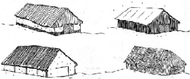
Une toiture sombre écrase le volume alors qu'une toiture claire le fera ressortir. Essayer de distinguer les éléments par les matériaux et les couleurs (soubassements, bardage, toiture..).
