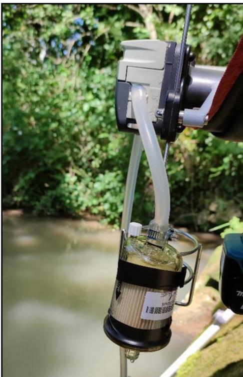
Photo. 1 : Filtre encapsulé relié à la tubulure qui prélève l'eau dans le milieu.
