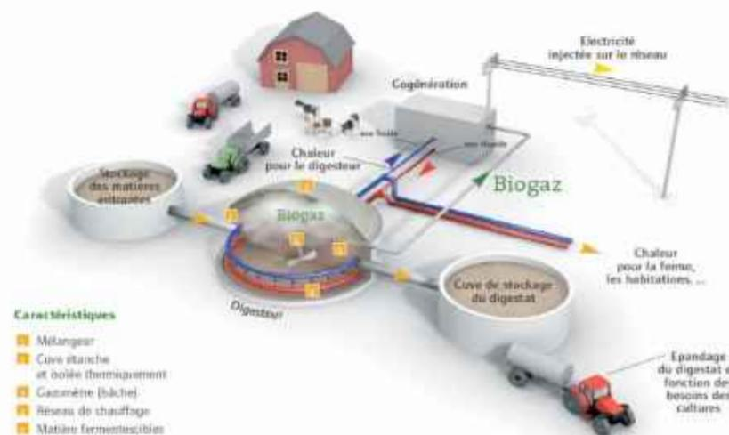
Principe de méthanisation à la ferme (Exemple de la ferme de l'hirondelle en Alsace)
